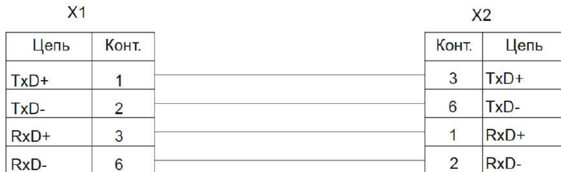
Рисунок М.1 - Схема прямого Ethernet-кабеля для подключения контроллера ГАММА-8МА к сетевому коммутатору
